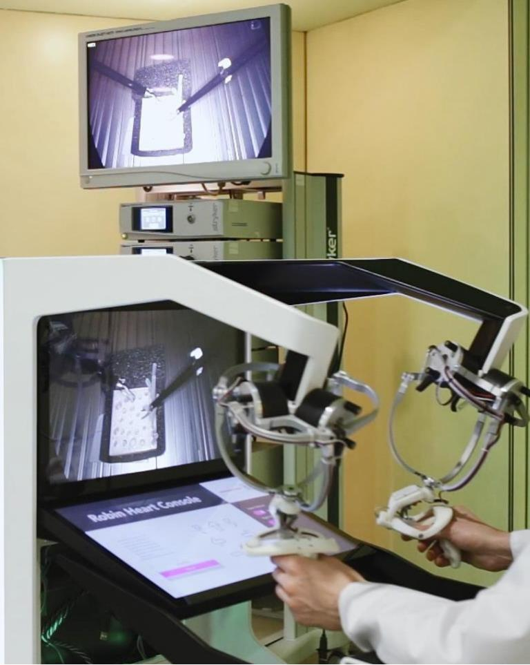
**Robin Heart AI:** „W trakcie pierwszej próby testowania automatycznej elektrokoagulacji robot ustawał się w miejscu wykrytego krwawienia, po czym wykonywał ruch w osi z, aż do osiągnięcia zamierzonej siły 10 N. Jednakże na dokładność wykonanego zadania wpływ miała bezwładność oraz prędkość hamowania narzędzia mechatronicznego. Po zakończonym treningu średnia siła wykonywanej elektrokoagulacji wyniosła 10,09 N, co znacznie przewyższa dokładność wykonywanego zabiegu ręcznie przez człowieka”
